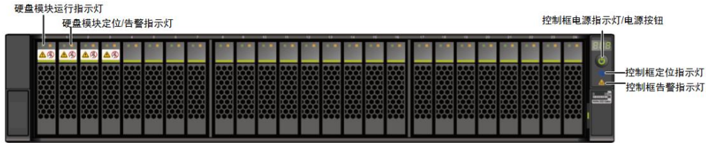
图1-41 2U 36 盘位控制框前面板指示灯
