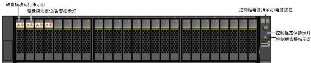
图1-12 2U 25 盘位控制框前面板指示灯
