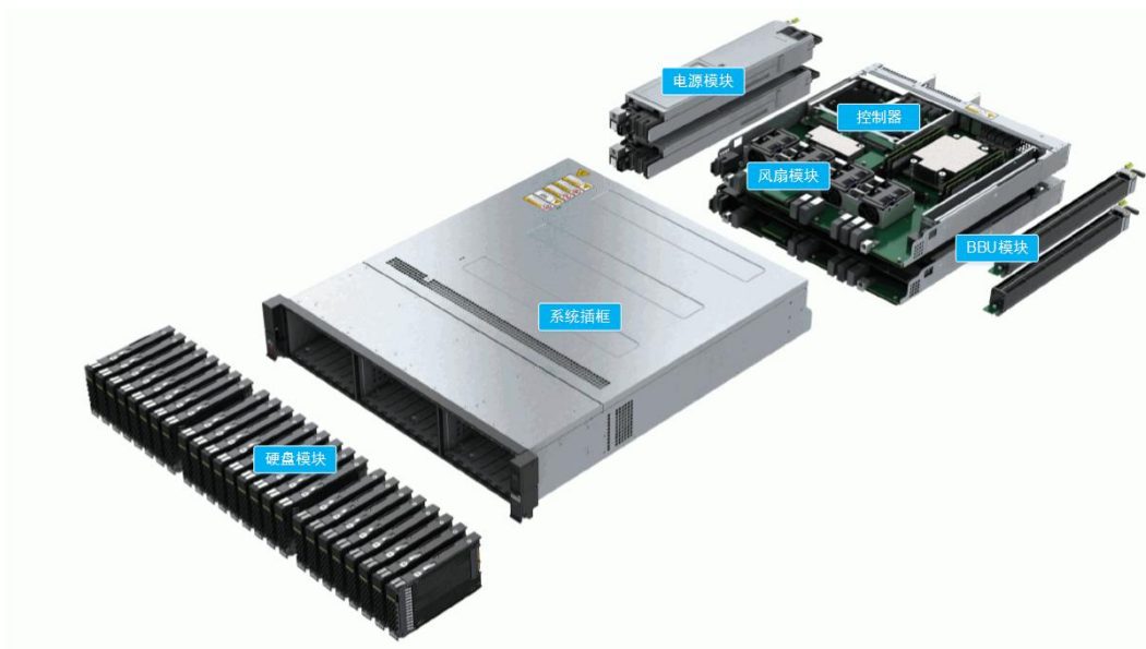
图1-14 2U 25 盘位控制框整体结构
