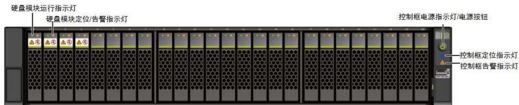
图1-25 2U 25 盘位控制框前面板指示灯
